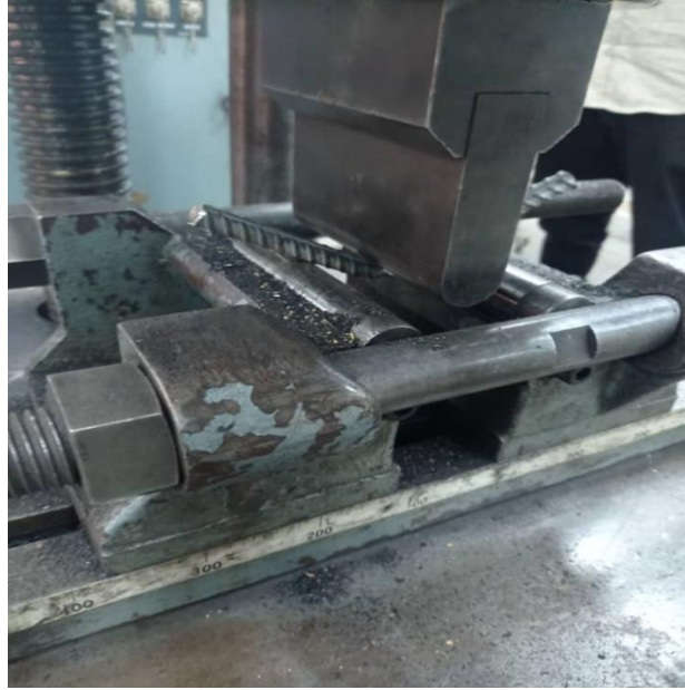
شكل (6): صورته توضيحية للحديد اثناء اختبار الثني.
