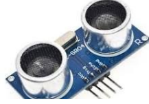
شكل (3): يوضح حساس (Ultrasonic)
