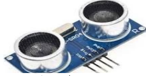
الشكل (6): يوضح حساس المسافة (Ultrasonic)
