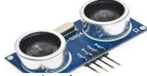
الشكل (6): يوضح حساس المسافة (Ultrasonic)
