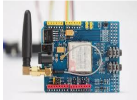
الشكل (8): يوضح لوحة (gsm module 900 arduino)
