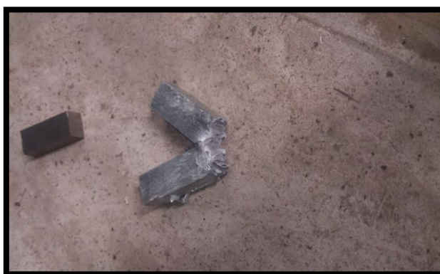
شكل (10): العينة المجلفنة بعد اختبار الصدم.
