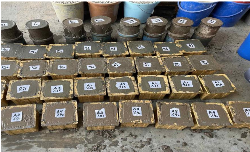
الشكل 4: العينات بعد الصب في القوالب والاسطوانات.
