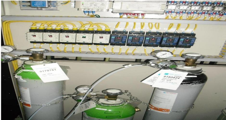
شكل (7). طريقة معايرة منظومة قياس انبعاث الغازات.
