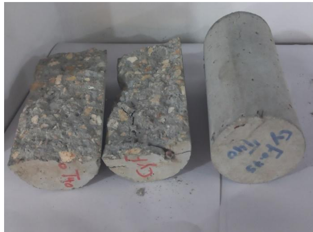
شكل رقم (14): العينات بعد التعريض لدرجات الحرارة والاختبار
