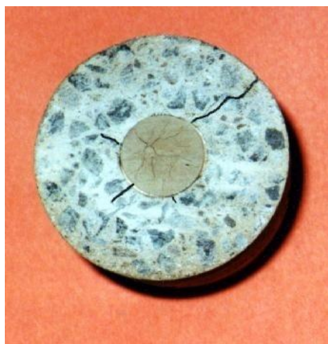
شكل رقم (1): التشقق الحراري الناتج عن التمدد العرضي لقضيب GFRP
