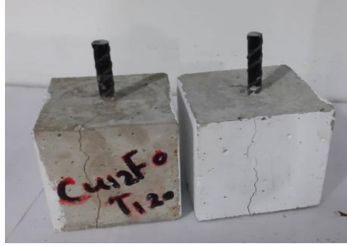
T120F0.75 T120F0 شكل رقم (21): نوع الانهيار بالنماذج بعد التحميل
