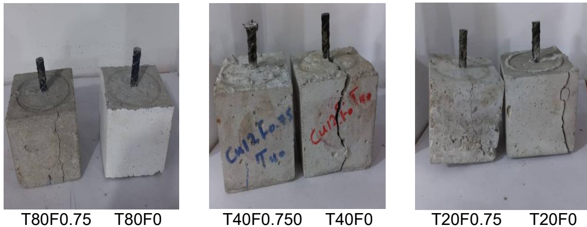
شكل رقم (20): نوع الانهيار بالنماذج بعد التحميل
