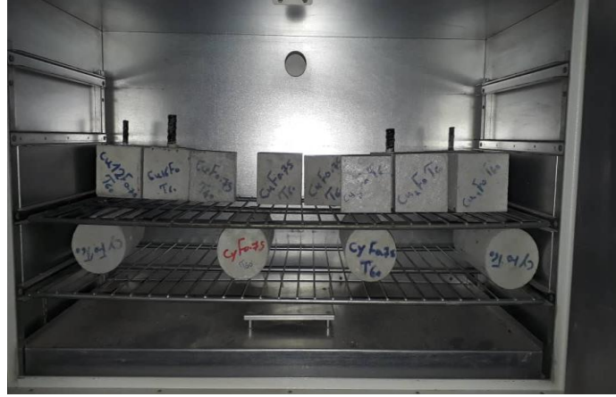
شكل رقم (4): عينات معرصة لدرجات الحرارة في الفرن
