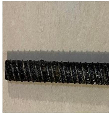
شكل رقم (3): قضبان الألياف الزجاجية GFRP
