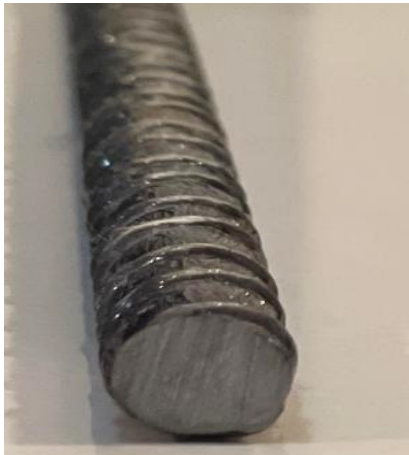
شكل رقم (3): قضبان الألياف الزجاجية GFRP
