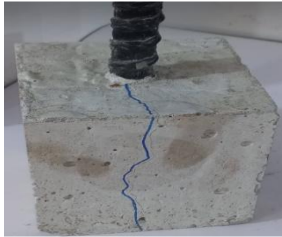
شكل رقم (9): التشقق الناتج عن الاختلاف في التمدد العرضي (120 م°)
