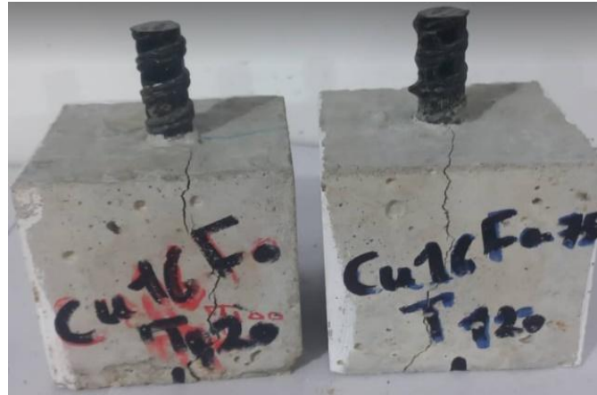
CU16F0T120 CU16F0.75T120 شكل رقم (23): نوع الانهيار في النماذج بعد التحميل
